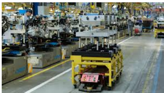
Ilustración 9.: AGV grupo Renault España. Factoría de Motores. Valladolid.
