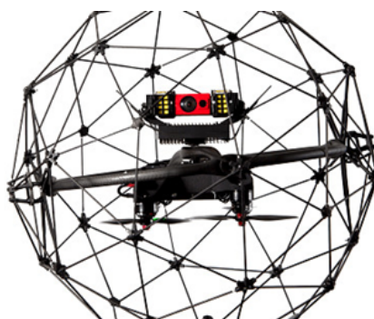
Ilustración 8. Dron especializado y destinado a espacios confinados. Fuente https://fanfan.es , 2 de junio de 2019
