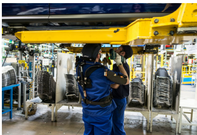
Ilustración 5. Operario trabajando con un exoesqueleto. Fuente www.xataka.com , 15 de junio de 2018
