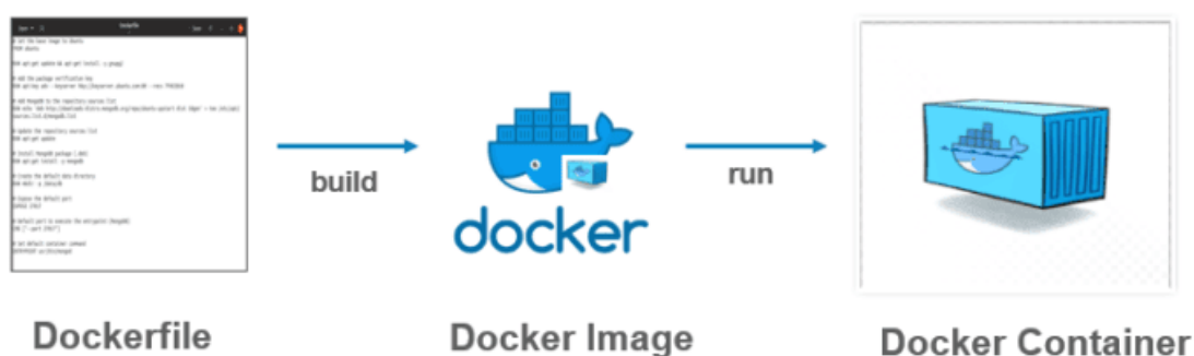
Figura 2: Proceso para la creación de una imagen mediante un archivo Dockerfile
