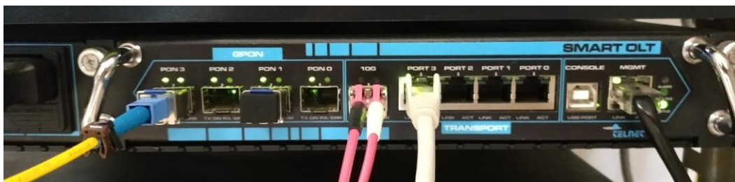
Figura 7: Imagen frontal de la OLT con los puertos PON y los puertos Ethernet
