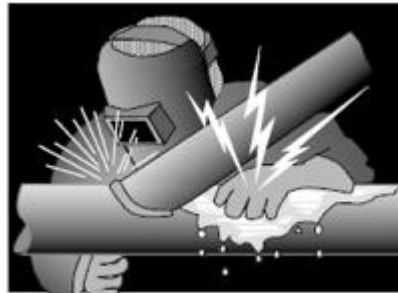
Figura 43. Evitar soldar con humedad. [10]
