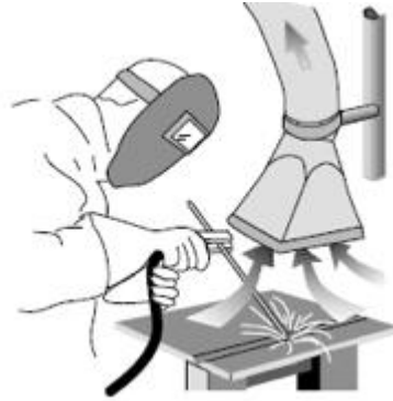
Figura 42. Soldar con equipos de extracción de humos. [10]
