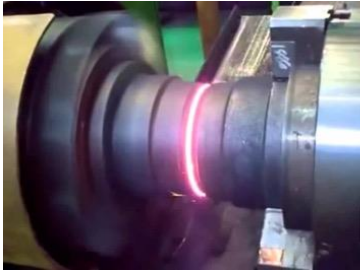
Figura 20. Soldadura por presión en caliente. [3]
