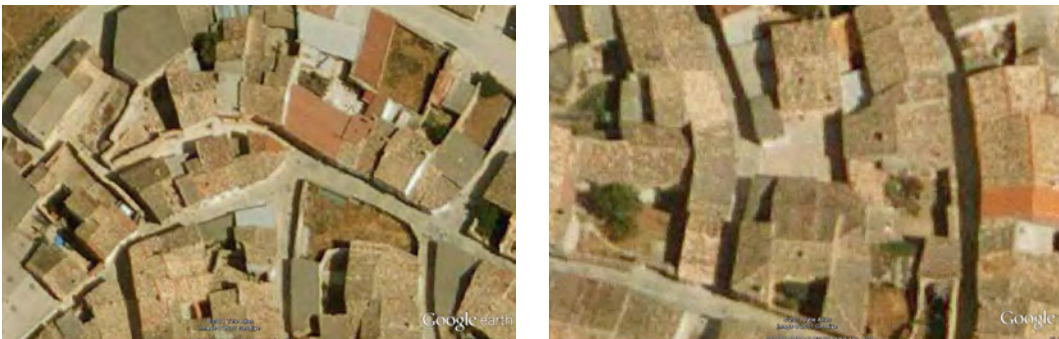
Fig.19. Captura de la ortofotografía del año 2010 publicada por ITACYL dentro del Plan Nacional de Ortofoto (visualización en Google Earth®). Al ser una orto convencional se observan fachadas proyectadas en el plano horizontal y otras deformaciones por la rectificación.
