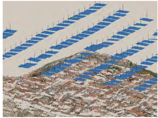
Fig. 29. Imagen con la trayectoria de vuelo del dron en Peñaflores de Hornija y puntos desde donde se han realizado las fotos (J. Martínez).
