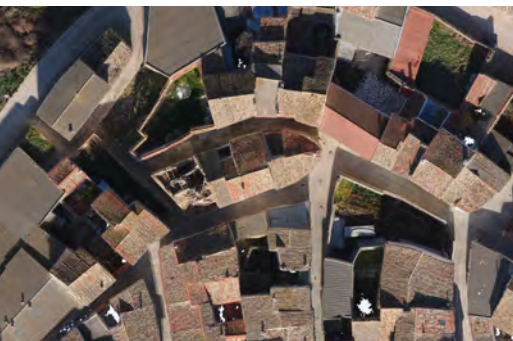
Fig. 20. Orto verdadera (true-ortho) derivada del vuelo con UAV en 2011. Mayor resolución y ausencia de errores en la proyección. Vertavillo.
