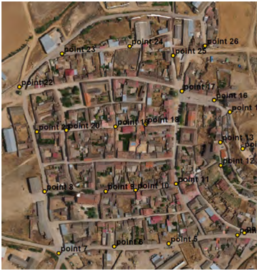
Fig.14. Distribución de puntos de apoyo medidos en el núcleo de Aguilar de Campos.
