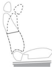
Ilustración 30. Ajuste de la parte superior del respaldo (EuroNCAP, Seat Movement Definitions, 2019).
