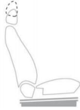
Ilustración 28. Ajuste del reposacabezas en dirección vertical (EuroNCAP, Seat Movement Definitions, 2019).
