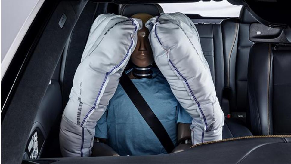
Ilustración 14. Airbag en desarrollo del modelo Mercedes-Benz GLE (Delgado, 2019).
