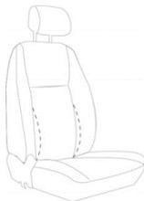
Ilustración 27. Ajuste del soporte lumbar (EuroNCAP, Seat Movement Definitions, 2019).
