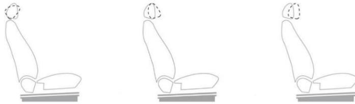
Ilustración 29. Ajuste del reposacabezas en dirección horizontal (EuroNCAP, Seat Movement Definitions, 2019).
