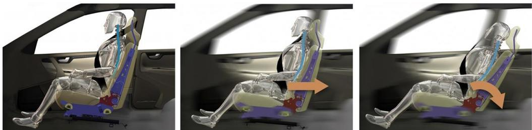
Ilustración 17. Fases activación mecanismo WHIPS de Volvo (Volvo Cars Whiplash System, 2008).
