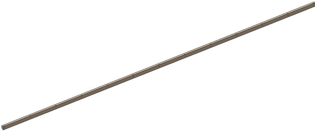
*Figura 15. Ejemplo de viga lateral de la plataforma (vigas 1 y 9)*
