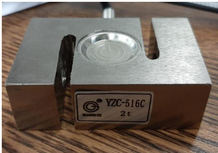
Figura 12. Célula de carga YZA-516C 2t
