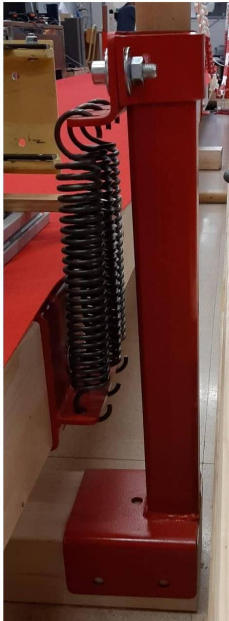
*Figura 8. Vista lateral de un apoyo elástico de la plataforma*
