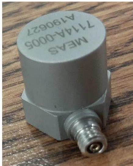
Figura 10. Acelerómetro MEAS 7114A
