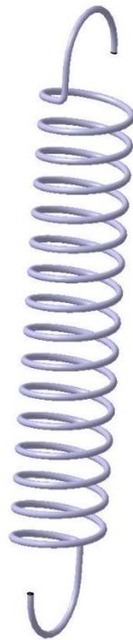
Figura 18. Resorte de tracción con 6632,65 N/m de rigidez
