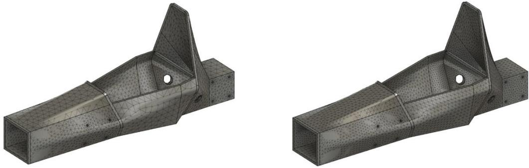
*Ilustración 75. Comparación malla 1 con la malla por defecto (Malla 1 ilustración derecha).*
