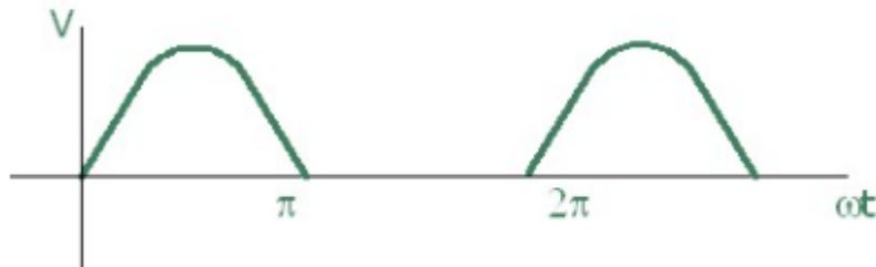
Figura 43 Onda de corriente en rect.monof. de media onda
