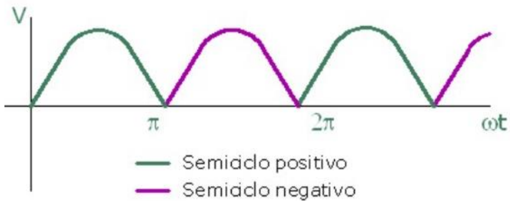
Figura 48 Tensión de rectificación onda completa en puente
