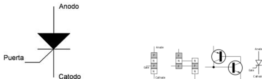
Figura 28 SÍMBOLO Y FORMA DEL SCR
