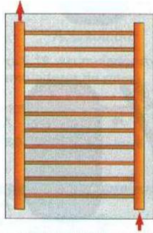
Figura 77. Absorbedor en forma de parrilla de tubos. Fuente: [18]
