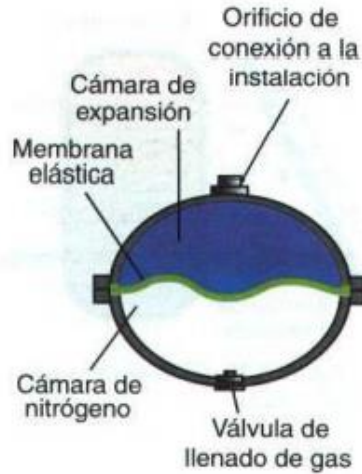
Figura 89. Infografía vaso de expansión. Fuente: [18]
