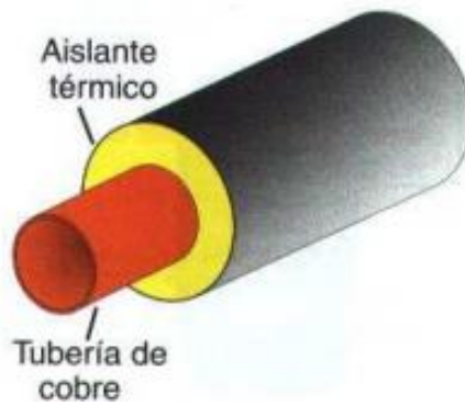
Figura 86. Infografía tubería de cobre. Fuente: [18]
