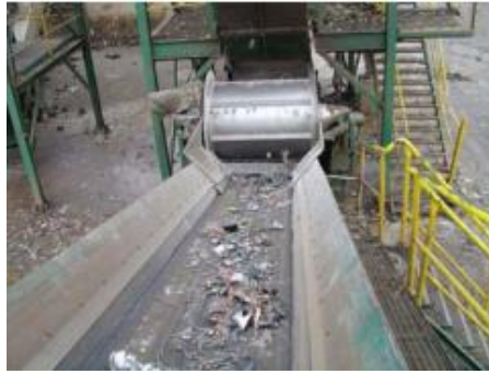
Figura 16. Tambor magnético para la separación de metales férricos. [Recuperado de: Ecolec Proceso de Reciclaje]
