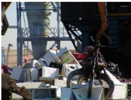
Figura 13. Brazo de grúa con pulpo hidráulico. [Recuperado de: Ecolec Proceso de Reciclaje]
