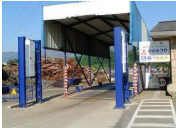
Figura 10. Vigilancia radiológica y báscula para el pesaje de mercancía. [Recuperado de: Ecolec Proceso de Reciclaje]
