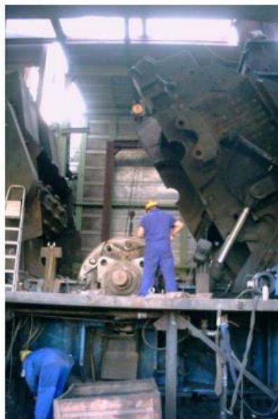
Figura 14. Molino de martillos situado dentro de la cámara de fragmentación. [Recuperado de: Ecolec Proceso de Reciclaje]
