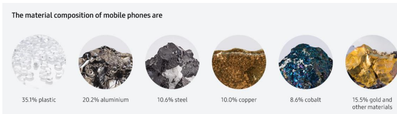
Figura 32. Composición material de un teléfono móvil. [Recuperado de: Eficiencia de recursos. Conservar, utilizar más tiempo y reutilizar]
