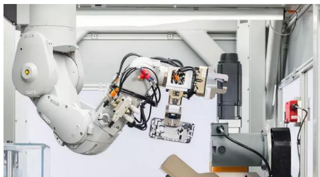
Figura 31. Robot de desmontaje Daisy. [Recuperado de: La Manzana Mordida. Daisy, el robot con el que Apple quiere ser más ecológica]
