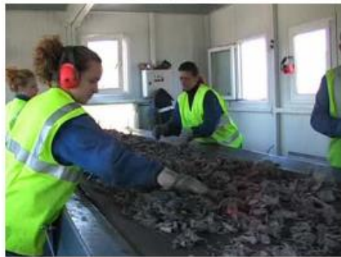
Figura 17. Puestos de triaje manual. [Recuperado de: Ecolec Proceso de Reciclaje]
