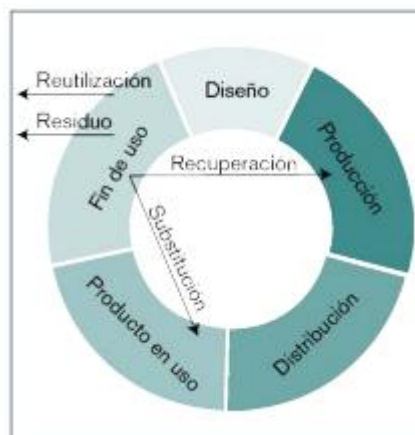
Figura 38. Esquema de las etapas del ciclo de vida de un producto. [Recuperado de: Jose Sierra-Pérez, Manuel Domínguez y María del Mar Espinosa. El ecodiseño en el ámbito de la ingeniería del diseño]
