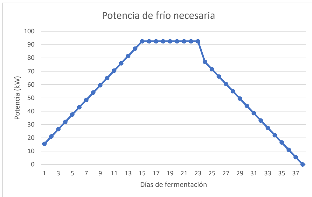
Figura 3.3. Producción de frío necesaria para la refrigeración de los depósitos
