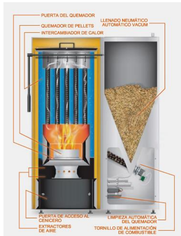
Figura 2.15. Esquema de funcionamiento de una caldera de pellets.
