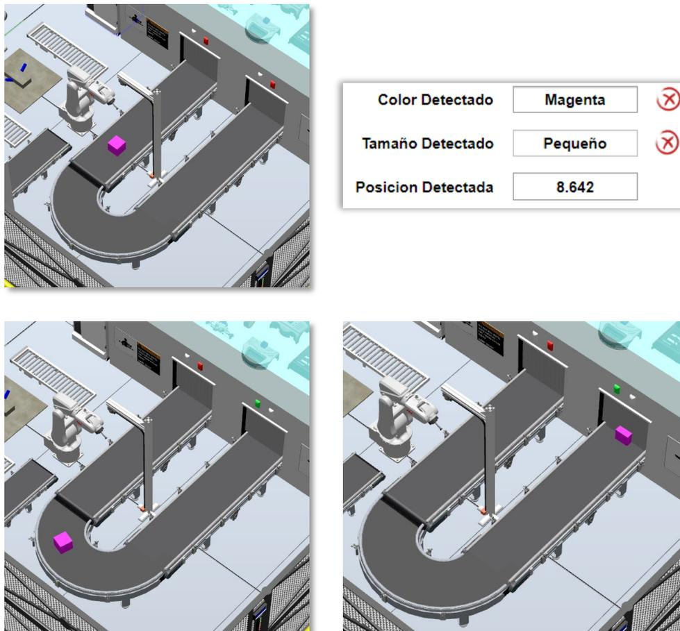
**Figura 132.** Secuencia de manipulación de una pieza incorrecta.
