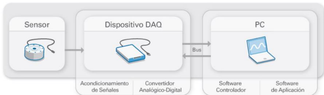
Figura 134. Esquema partes de un DAQ [21]
