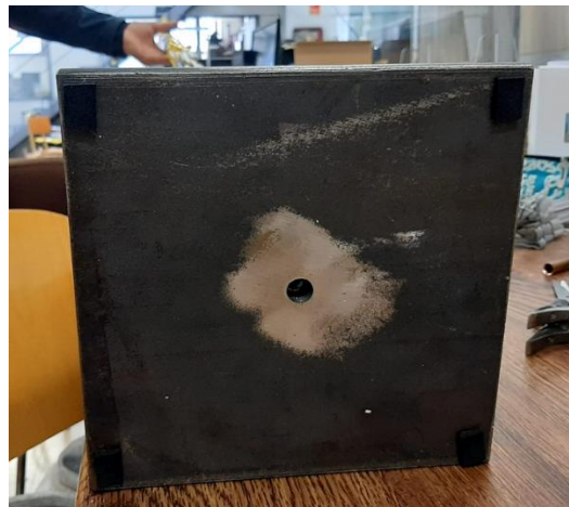
Figura 48. Base prototipo con antideslizantes de caucho
