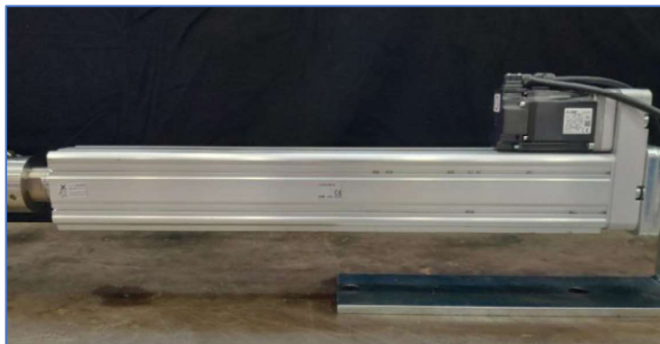
Fig. 2: Actuador Ley63NZC-400 de SMC
