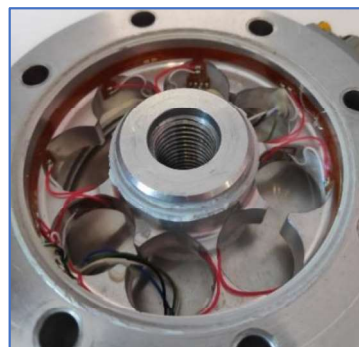
Fig. 37: Interior de una célula de carga
