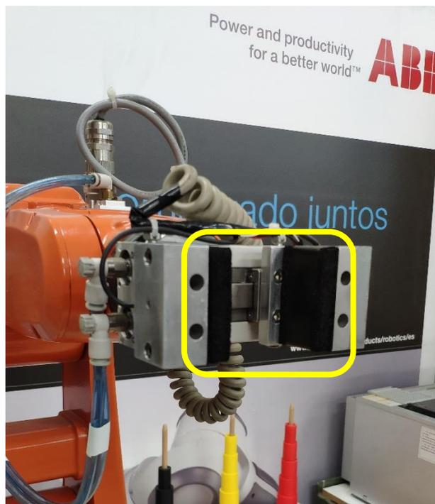
Figura 58. Almohadillas en la pinza del robot IRB 120
