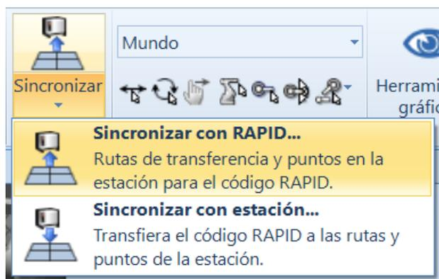
Figura 39. Sincronización con RAPID de la estación
