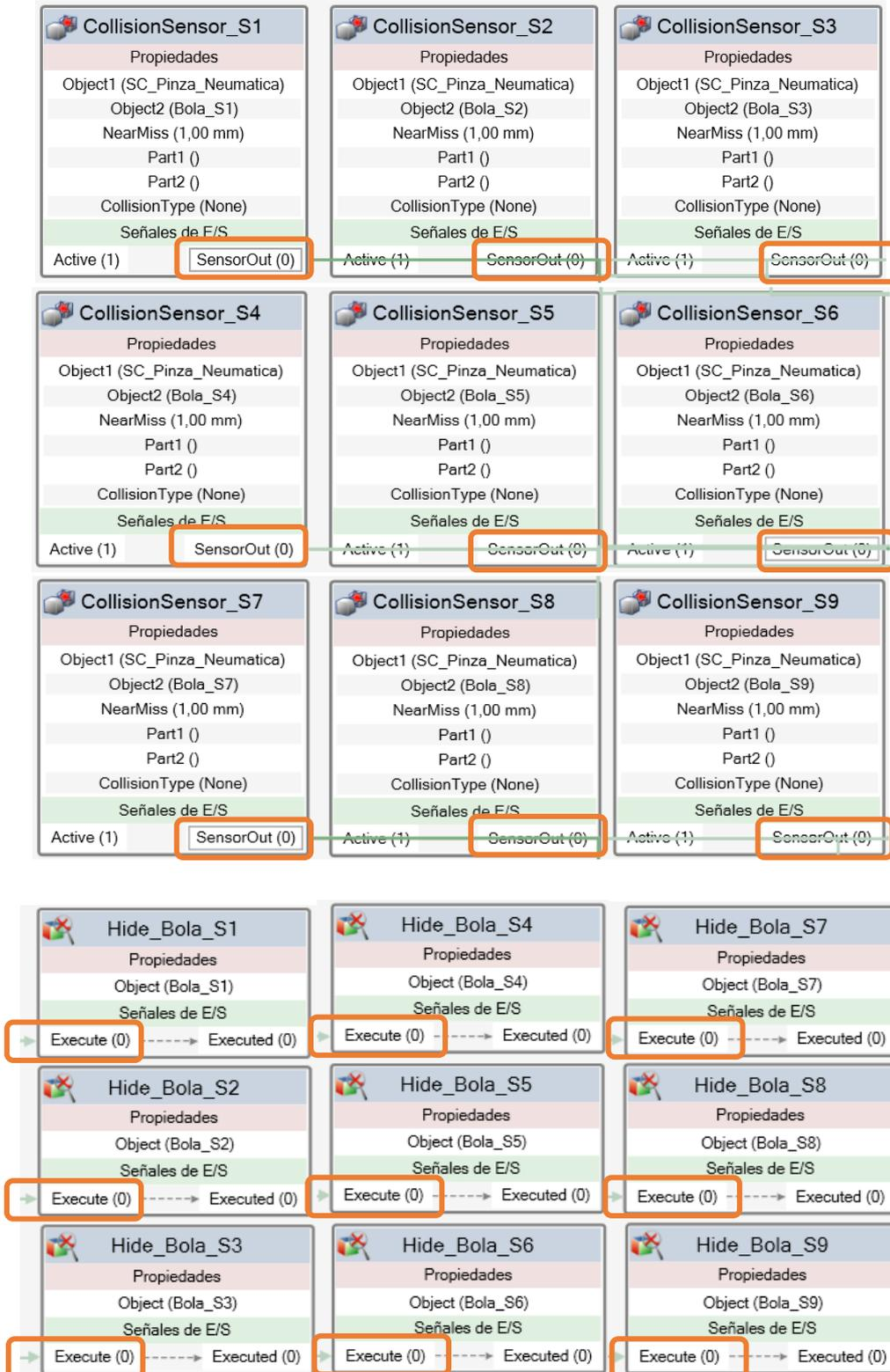
Figura 36. Lógica de estación. Configuración para la desaparición de la bola en la posición S1 del tablero
