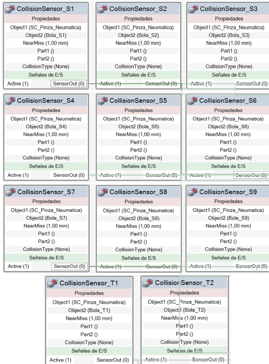
Figura 23. Lógica de estación. Componentes CollisionSensor de la estación
