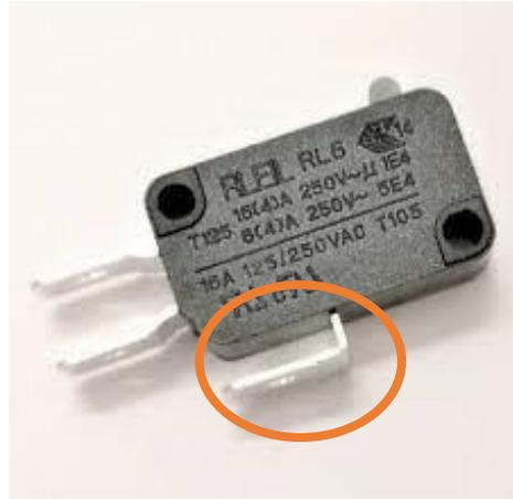
Figura 79. Terminal neutro del sensor
