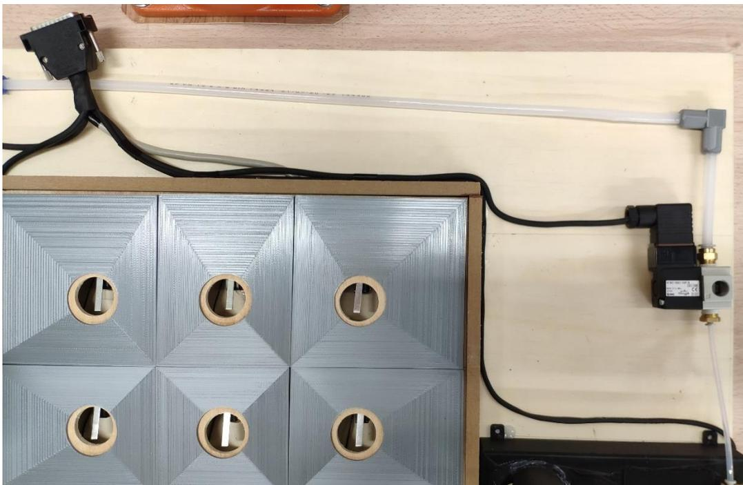
Figura 71. Cableado eléctrico y neumático en la práctica real (parte derecha)
