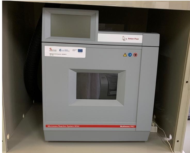
Figura 4.5: Equipo de extracción por microondas
