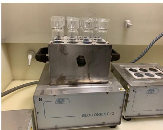
Figura 4.10: Equipo de digestión utilizado en el laboratorio
