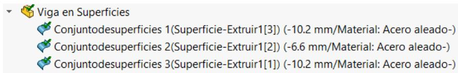
Figura 38: Material y espesor de las superficies de la viga en modelo superficial
