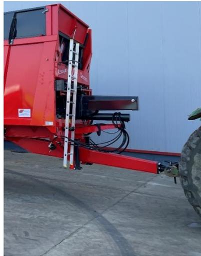
Figura 12: Detalle de la lanza de un remolque
