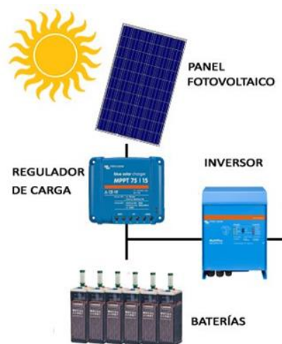
Figura 111. Esquema de generación de tensión a partir de un panel fotovoltaico
