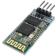
Ilustración 73: Módulo bluetooth HC-06
