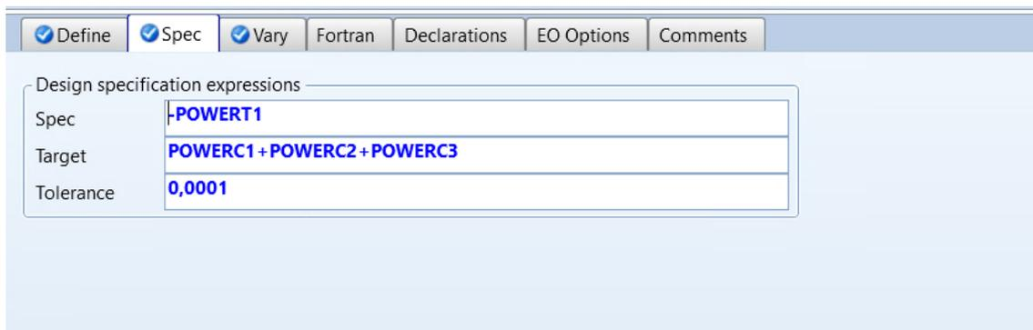
Ilustración 9: Balance de potencias en Design Specs
