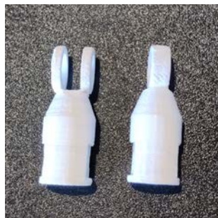
Figura 29: Articulación secundaria, versión 1 impresa
