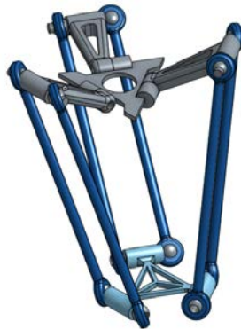
Figura 11: Robot Delta usando rótulas
