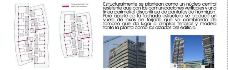
Estructuralmente se plantean como un núcleo central resistente que con las comunicaciones verticales y una línea perimetral discontinua de pantallas de hormigón. Pero aparte de la fachada estructural se produce un vuelo de losas de forjado que va cambiando de tamaño que da lugar a amplias terrazas y modela tanto la planta como los alzados del edificio.
