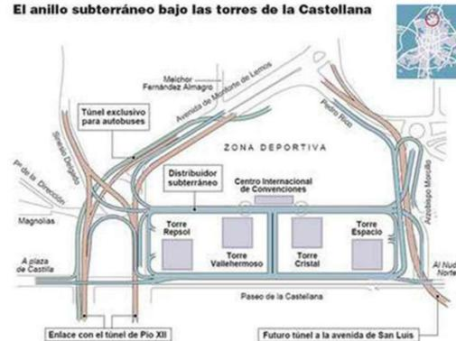
Imagen 5. Plano subterráneo, conexiones de las Cinco Torres.
