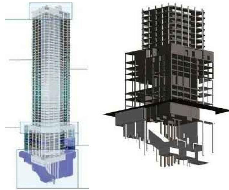
En la planta inferior surge un acceso independiente a la línea de ferrocarril. La estructura se conforma por un núcleo central que contiene los accesos verticales de comunicación y de instalaciones; y una línea pilares en el perímetro (retranqueados de los bordes para apoyar las grandes ventanas).
