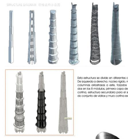
Esta estructura se divide en diferentes capas. De izquierda a derecha: núcleo rígido, megacolumnas antenas a esta, torjados divididos en los 8 módulos, primera capa de muro cortina, estructura secundaria para el segundo conlino de vientos y muro cortina exterior.
