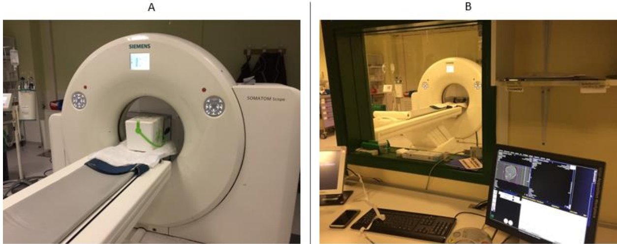
Figura 2. Obtención de las imágenes de TC A: Se observa la máquina de TC Siemens Somatom Scope 16 así como una de las cajas con una de las cabezas usadas en el estudio. B: Vista desde la sala radioprotegida donde se controla la máquina de TC.
