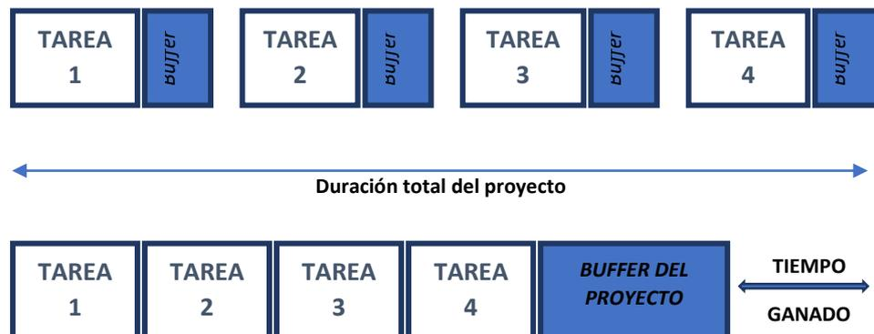
Ilustración 16- Diagrama Ilustrativo buffer de proyecto. Fuente: Elaboración propia
