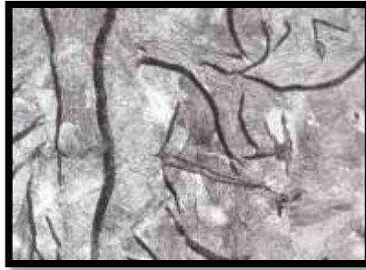
Ilustración 23. Perlita en una fundición gris. [6]
