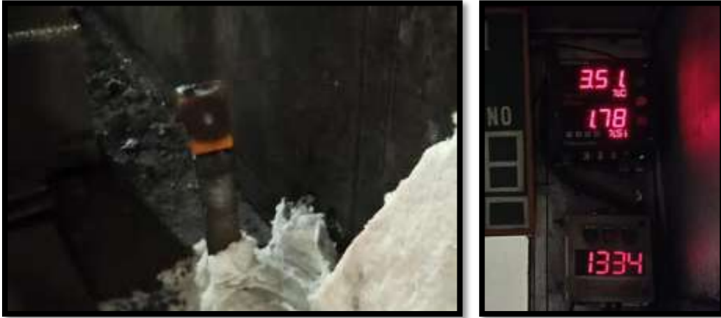
Ilustración 10. Sistema para la toma de muestra y pantalla de valores del Carbodeterminador.
