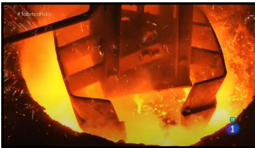
Ilustración 8. Retirada de la escoria. [2]
