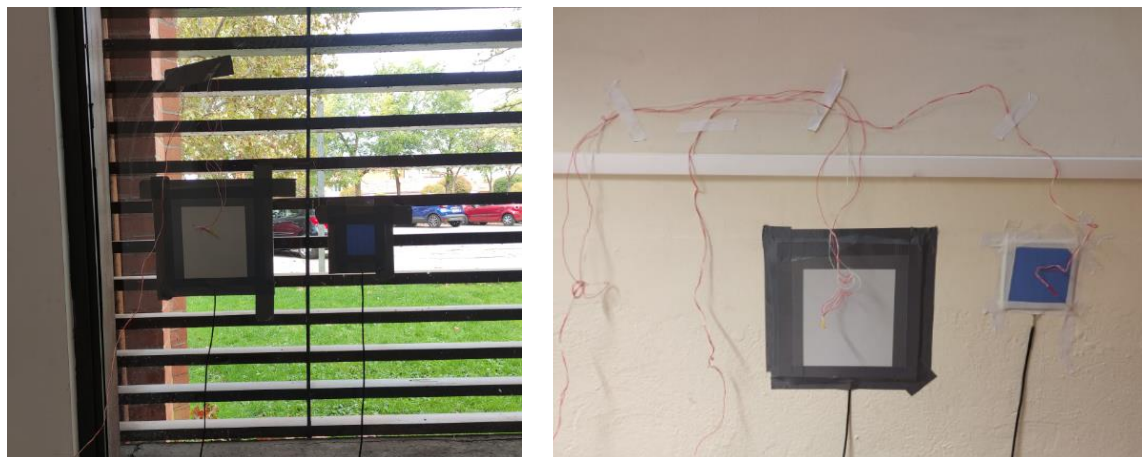
Figura IV. 18. Medición de figuras "in situ" con termoflujómetros
