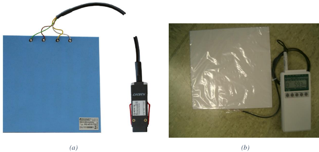
Figura IV. 17. Termoflujómetros disponibles (a) ALMENO FQA018CSI (b) ALMENO FQA019C
