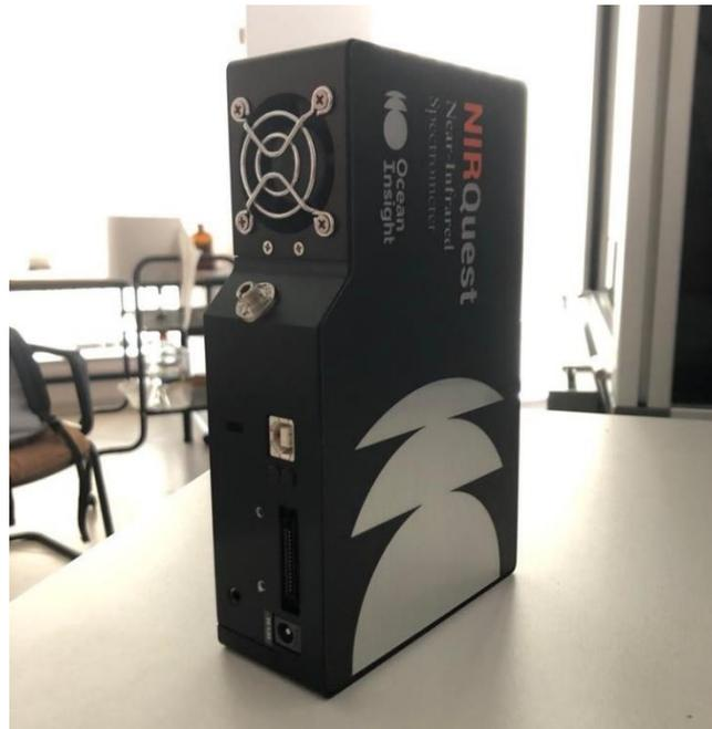
Figura 49. Espectrómetro utilizado en el sistema.
