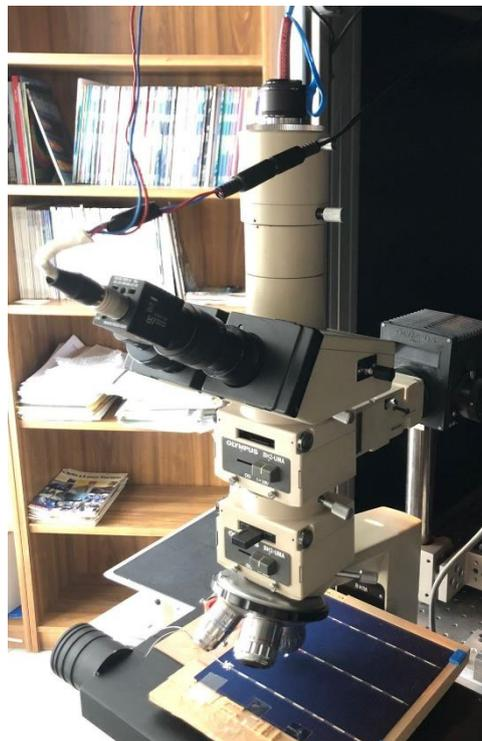
**Figura 50.** Disposición de la cámara y fibra del espectrómetro en el microscopio.
