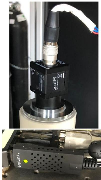
**Figura 12.** Cámara de video y (ab) capturadora USB.
