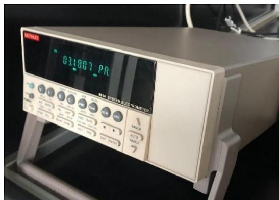
Figura 11. Electrómetro del sistema.
