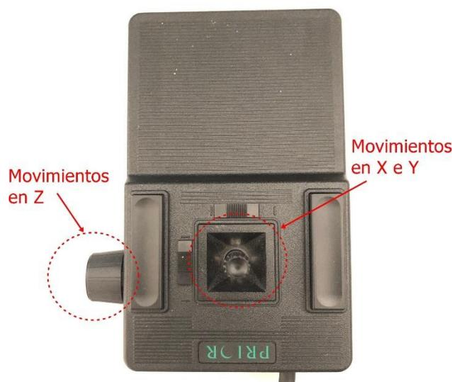
Figura 20. Colocación del joystick para el movimiento correcto de la mesa.
