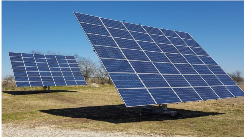
Ilustración 8. Estructura solar seguimiento en 2 ejes.
