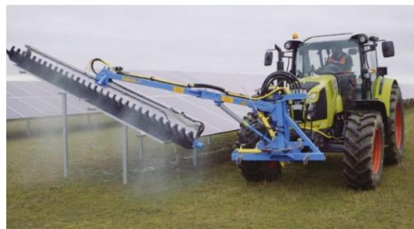
Ilustración 31. Limpieza de módulos Fotovoltaicos.
