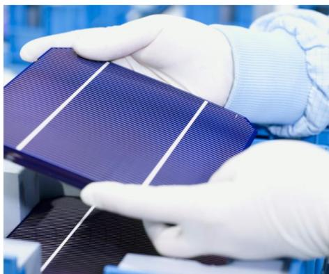
Ilustración 3. Célula fotovoltaica.
