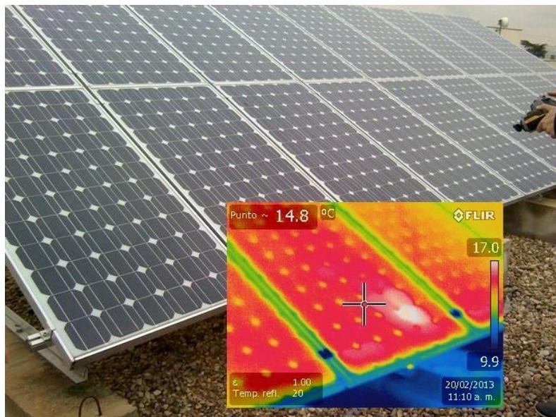
Ilustración 35. Imagen termográfica panel fotovoltaico.
