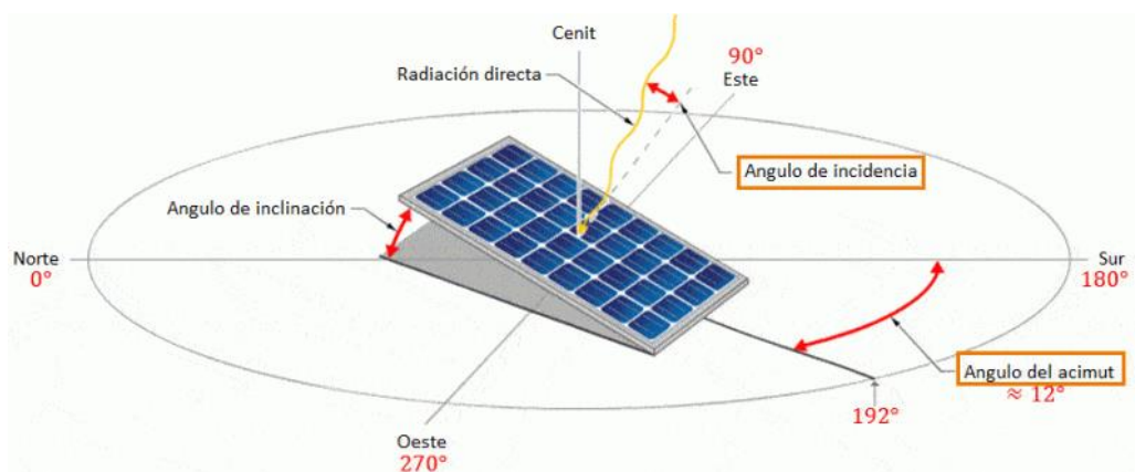
Figura A3.5. Esquema de ángulos de una placa solar.
