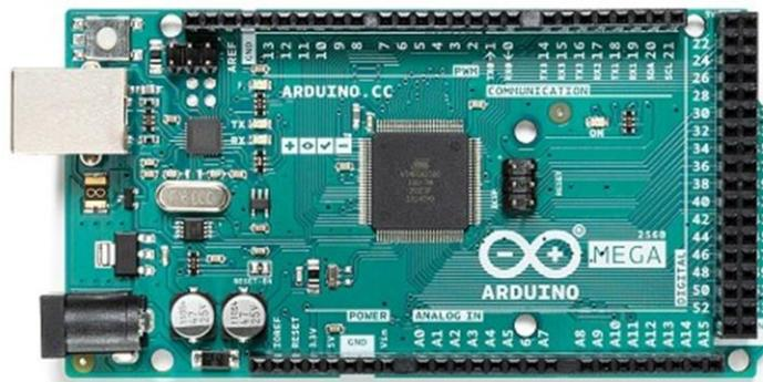
Figura 33. Placa Arduino Mega 2560.[21]
