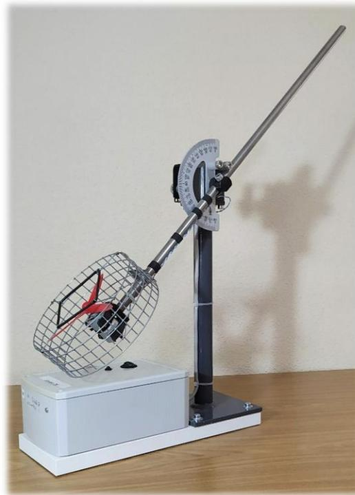
Figura 2. Modelo Balancín con Motor y Hélice.
