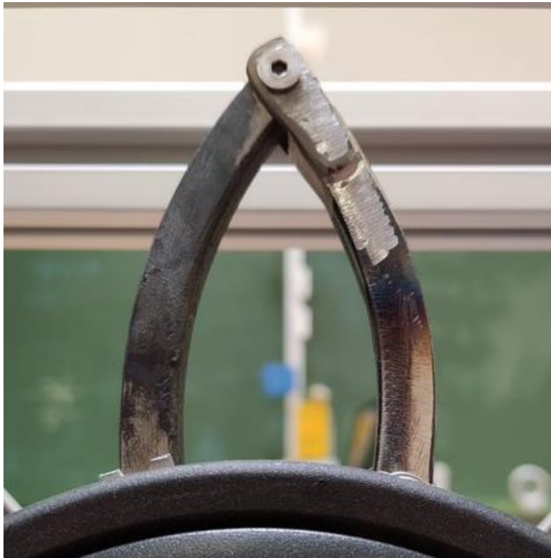
Figura 44. Resultado de la masa excéntrica en su posición de mayor excentricidad
