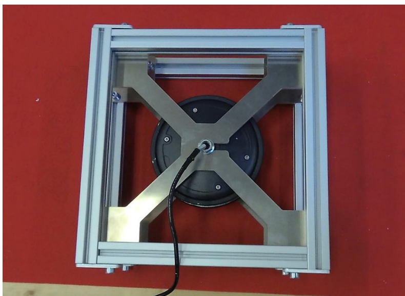
Figura 40. Conjunto completo de la "caja" sobre el que se anclarán las "patas"
