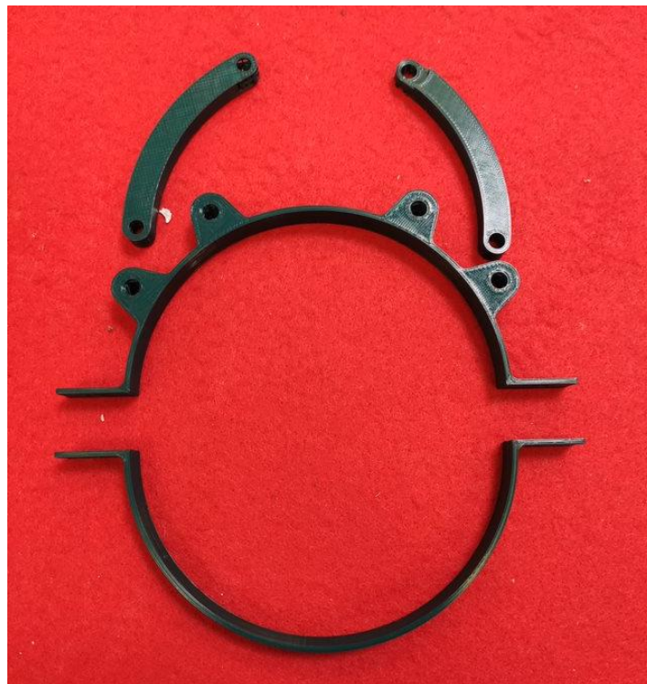
Figura 31. Resultado de la impresión en 3D del conjunto masa excéntrica
