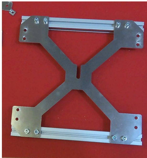
Figura 33. Primera unión entre perfiles Fasten y “placa horquilla”
