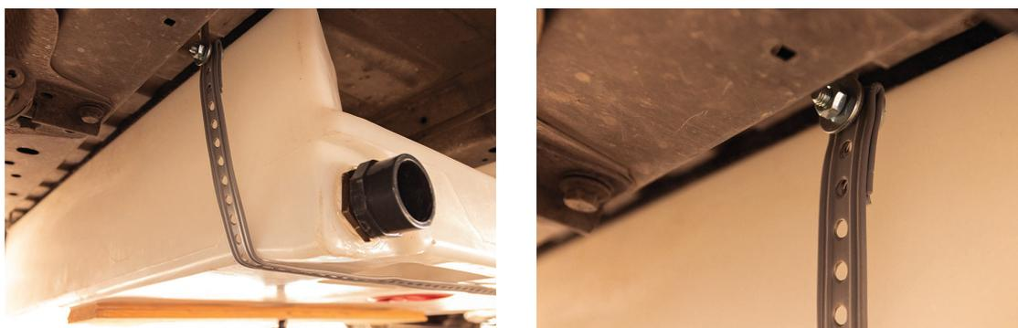
fig 39. Instalación del depósito de aguas residuales
