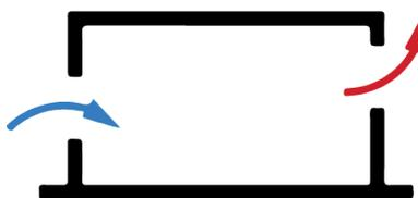
fig 34 . Diagrama de ventilación cruzada.
