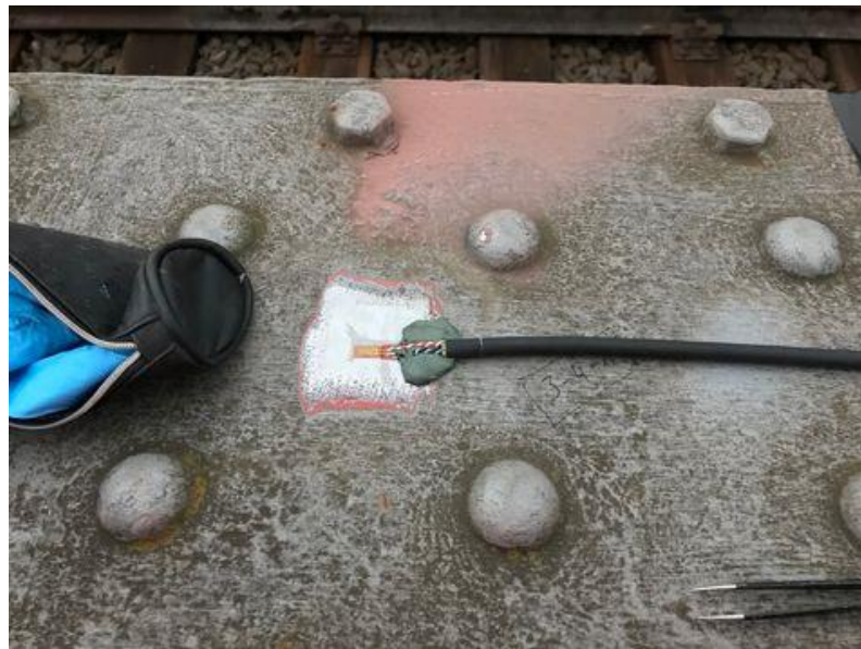
Figura 3: Galga extensiométrica lineal en un elemento portante.[3]
