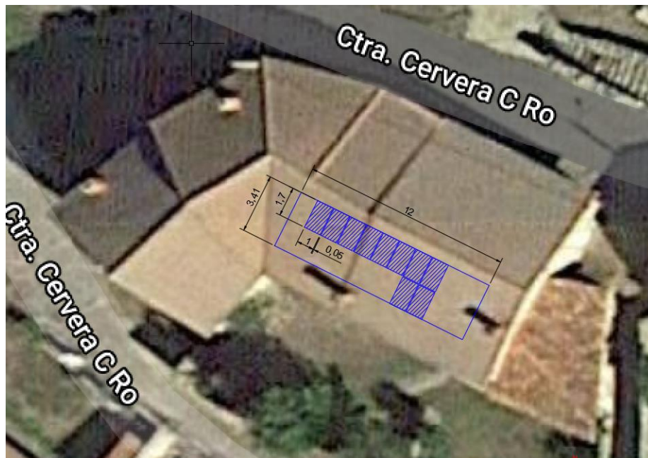
Figura 41: Ubicación de los paneles fotovoltaicos
