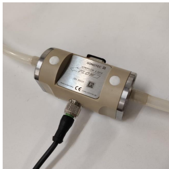
Figura 2.12. Caudalímetro “fijo” para tubos de 10mm Sonoflow de Sonotec®.
