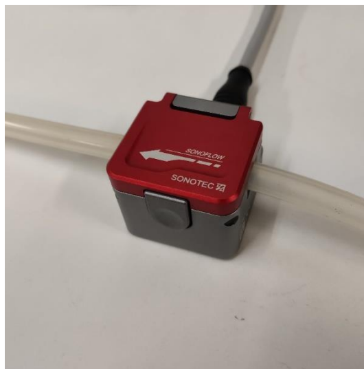
Figura 2.11. Caudalímetro “móvil” para tubos de 10mm Sonoflow de Sonotec®.
