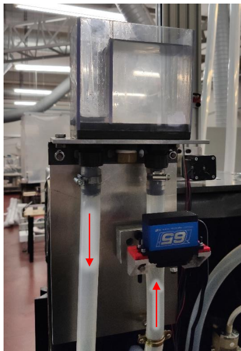
Figura 3.6. Detalle de la colocación del servomotor a la salida del modelo.
