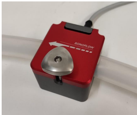
Figura 2.13. Caudalímetro “móvil” para tubos de 20mm Sonoflow de Sonotec®.
