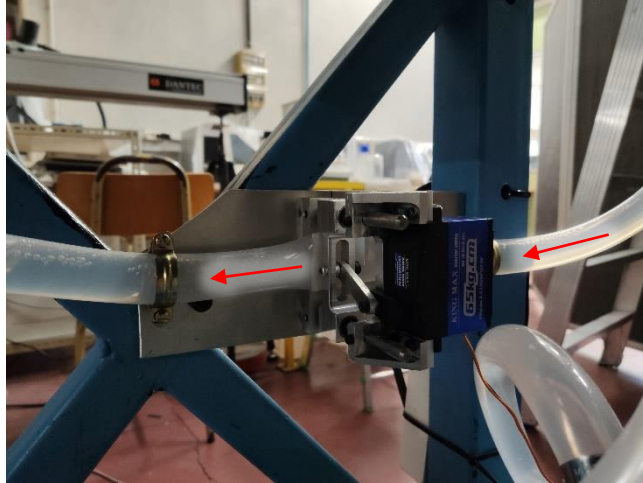
Figura 3.7. Detalle de la colocación de la electroválvula 2 de la entrada del modelo al depósito inferior.
