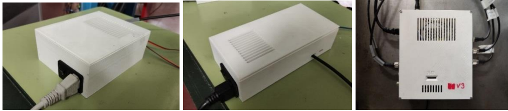
Figura 2.7. De izquierda a derecha: caja de control de las electroválvulas, caja de control de los motores paso a paso del depósito y del desplazador del modelo y caja general de conexiones.
