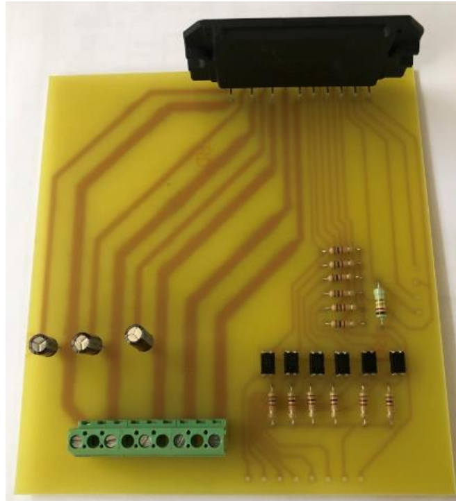
Figura 69: Resultado final de la PCB. (Elaboración propia)
