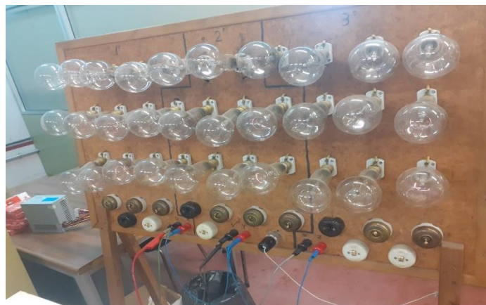
Figura 80: Carga resistiva en estrella. (Elaboración propia)
