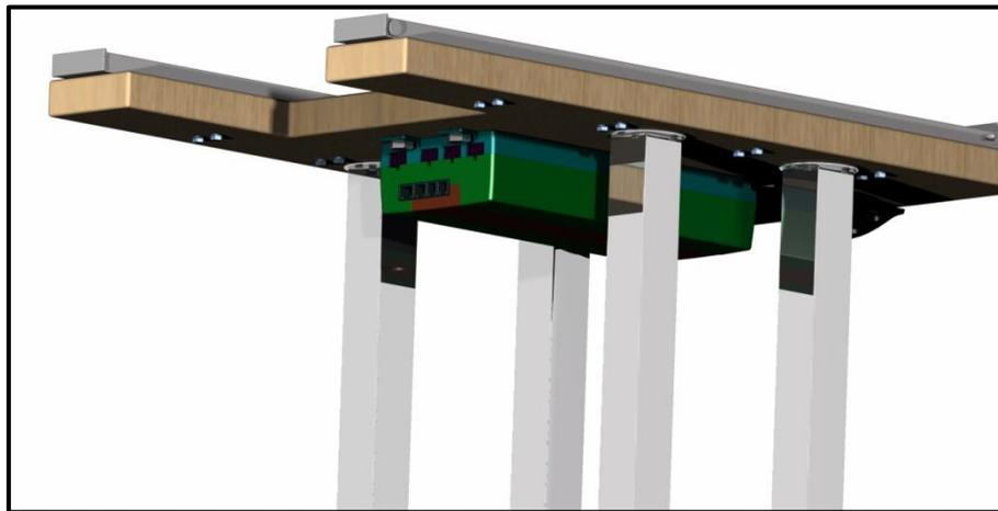
Figura 47: Caja de control o fuente de alimentación de las unidades lineales SLA.
