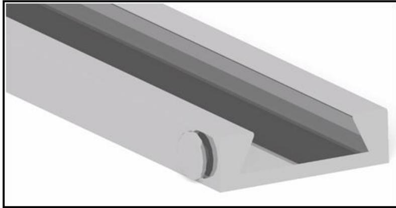
Figura 42: Cilindros delanteros de las guías del sistema de unión entre la plataforma Intermedia y la mesa auxiliar de apoyo. Fuente: Elaboración propia
