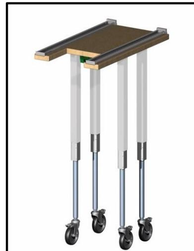
Figura 39: Mesa auxiliar de apoyo en posición extendida.
