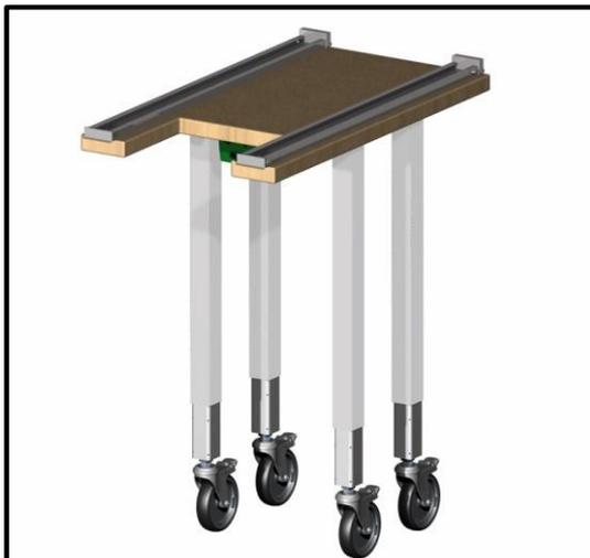
Figura 38: Mesa auxiliar de apoyo en posición recogida.
