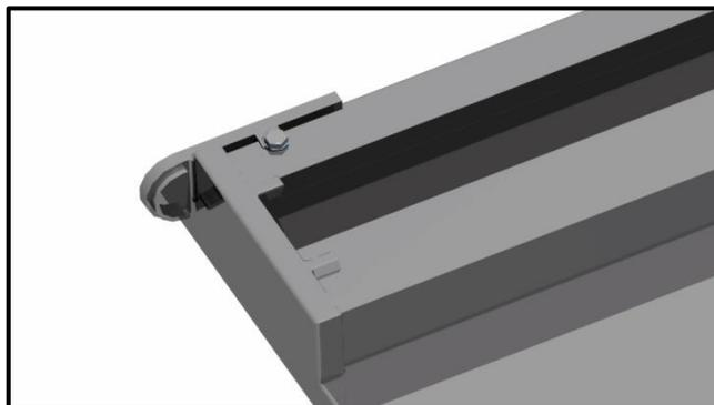
Figura 35: Detalle del sistema de anclaje y de los topes traseros de las guías.
