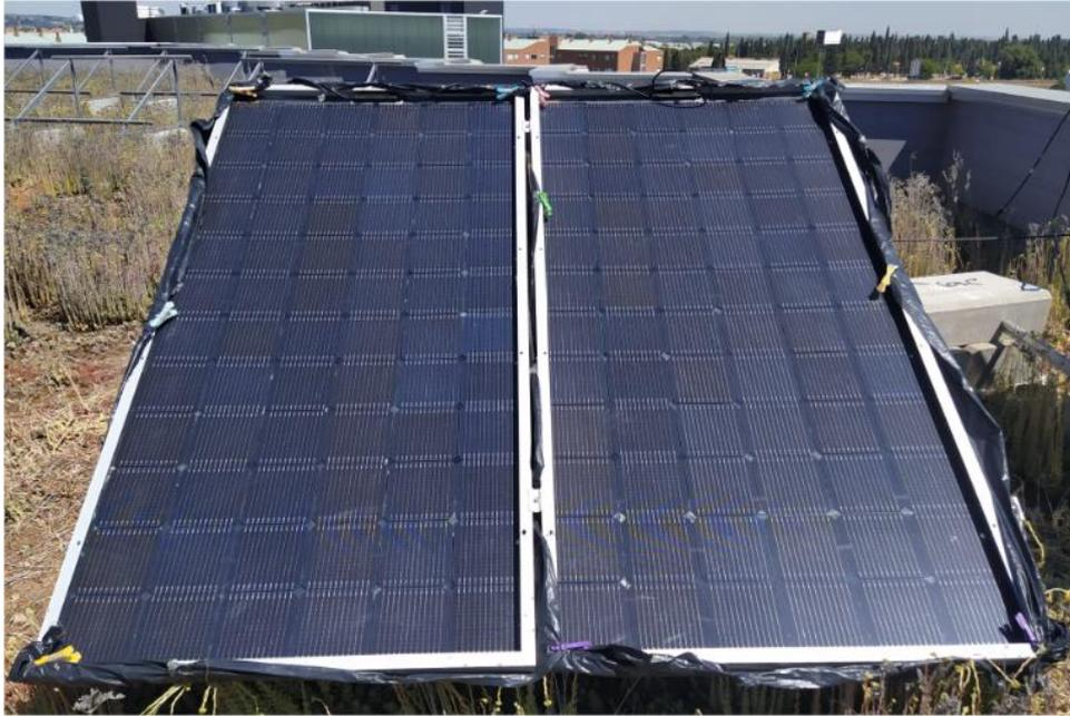
Figura 46. Disposición del módulo para obtener la característica I-V de la parte trasera. Fuente: Elaboración propia
