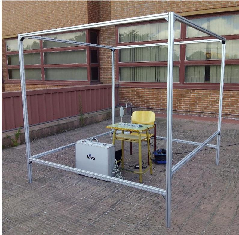
Figura 46 - Estructura portante y equipo de medida de confort térmico en el interior.
