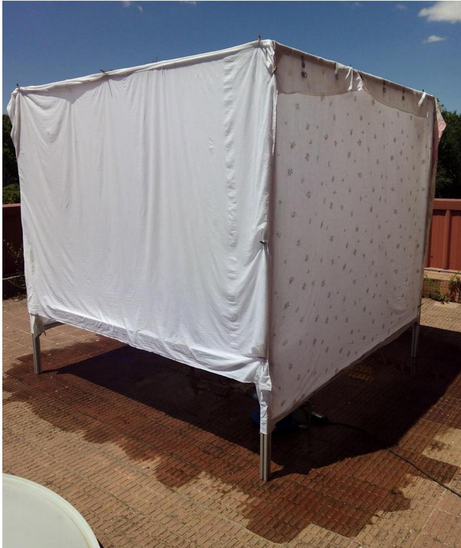
*Figura 49 – Estructura portante con telas humedecidas por agua.*
