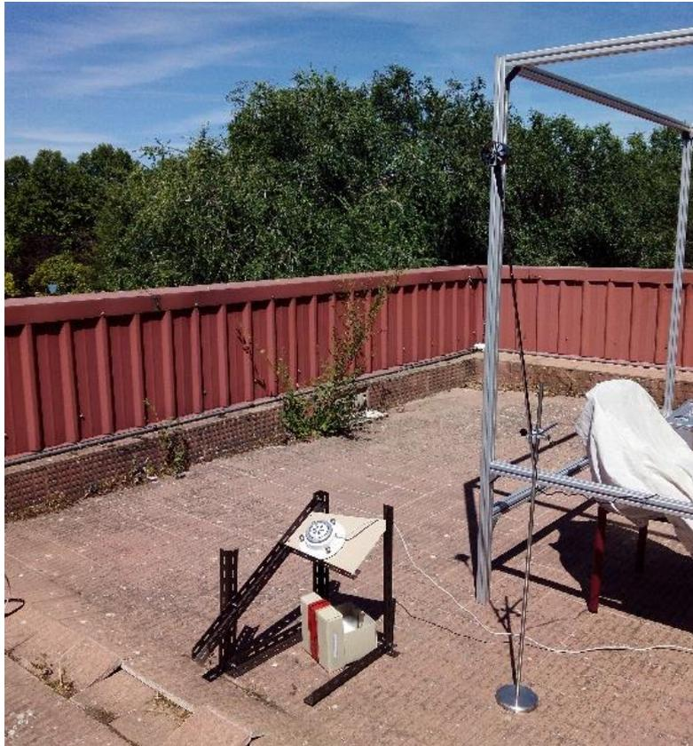
*Figura 48 – Piranómetro y sonda de molinillo Testo 435*
