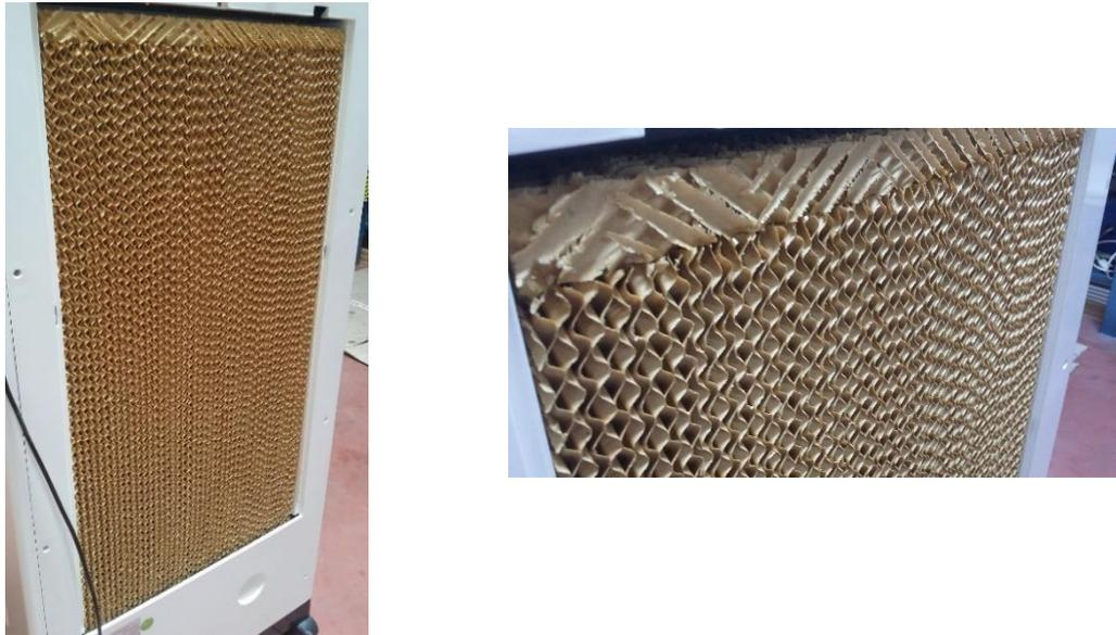
*Figura 11 - Parte posterior de un equipo de enfriamiento evaporativo de relleno rígido. (Fuente propia).*
