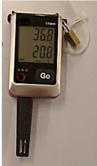
*Figura 20 - Sonda de temperatura seca y humedad relativa Testo 175H1.*
