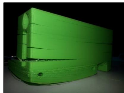
Captura 53: Efecto cracking
