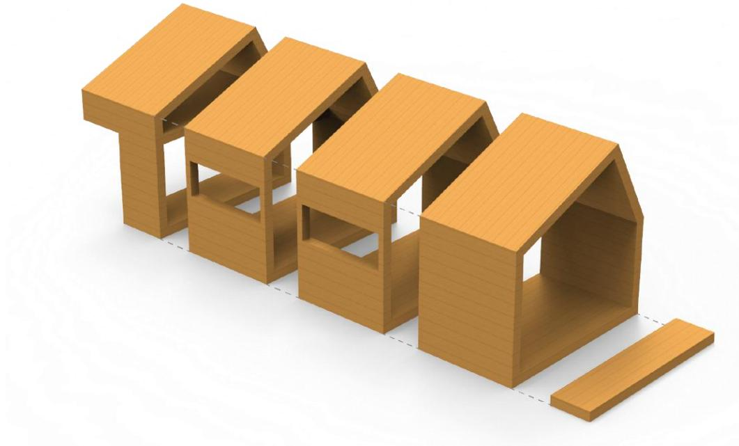
*Ilustración 42: Paso 2 montaje estructura. Unión de las 4 secciones*
