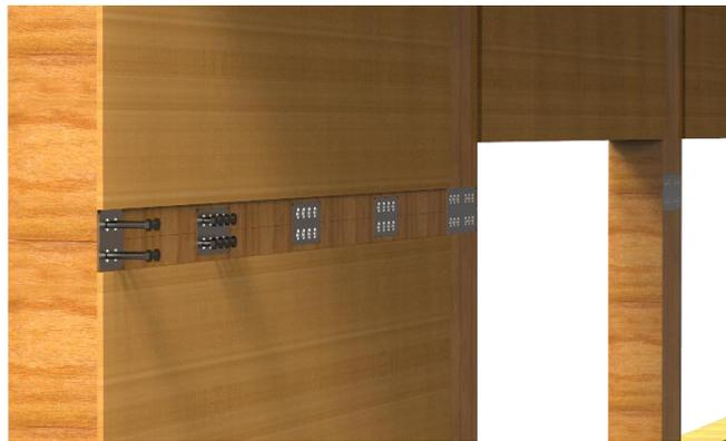
*Ilustración 40: Chapas de acero distribuidas*
