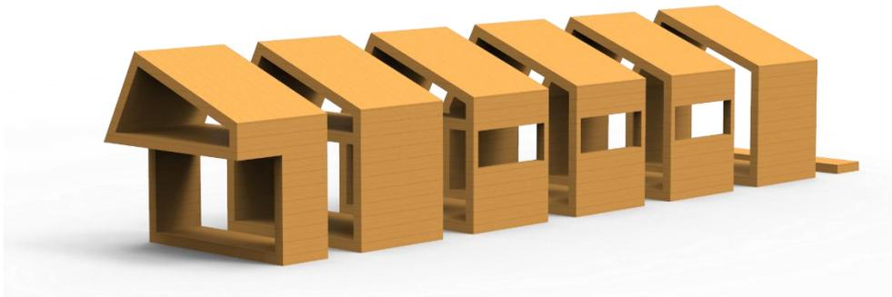
*Ilustración 87: Ampliación de la superficie de la habitación con una pequeña modificación en el segundo módulo*
