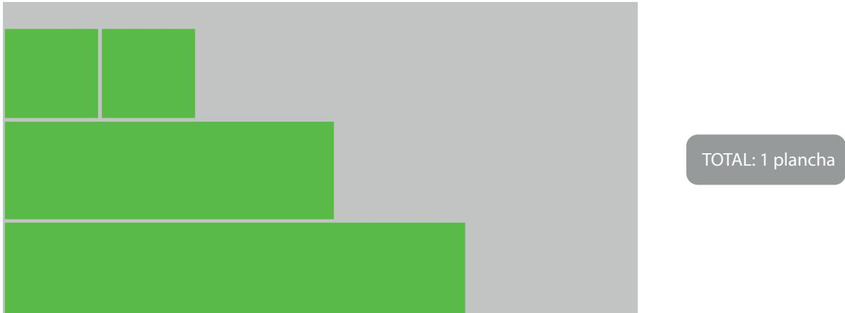
Figura 91: Distribución tablero contrachapado de chopo 15 mm
