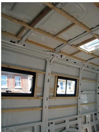
Figura 71: Revestimiento del chasis
