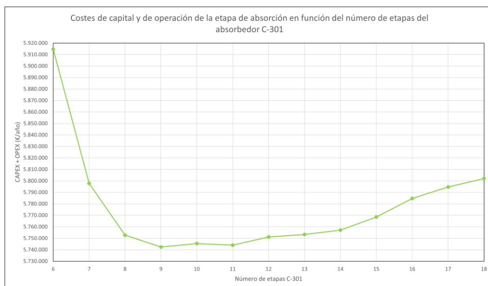
Figura 6.37. Costes de capital más costes de operación (CAPEX + OPEX) de la etapa de absorción en función del número de etapas del absorbedor C-301. Temperatura de entrada del disolvente: 15°C.
