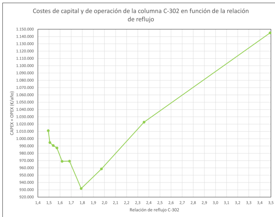
Figura 6.45. Costes de capital más costes de operación (CAPEX + OPEX) de la columna C-302 en función de la relación de reflujo.
