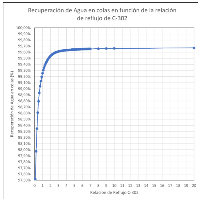
Figura 6.40. Recuperación de Agua en la corriente de colas en función de la relación de reflujo de C-302. Fracción molar de Agua 0,9995.
