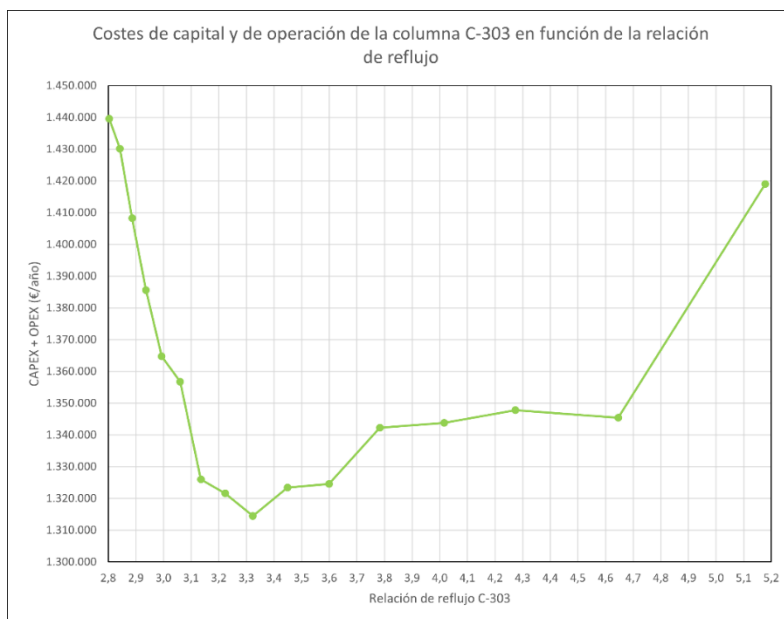
Figura 6.46. Costes de capital más costes de operación (CAPEX + OPEX) de la columna C-303 en función de la relación de reflujo.
