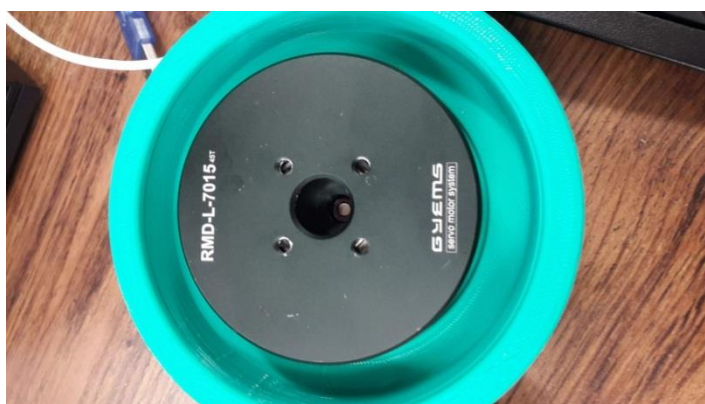
Figura 11. Motor brushless RMD-L-7015 de 'Gyems' apoyado sobre un soporte verde.
