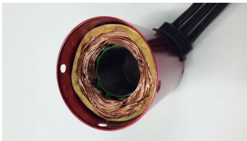
Figura 9. Estator del motor brushless , tras haber retirado el rotor para poder ver los pocos polos que tiene.
