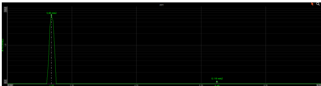
Figura 91. FFT obtenida con Dewesoft que indica las frecuencias de los modos 1 y 2, que son 1.367 y 6.49 Hz.
