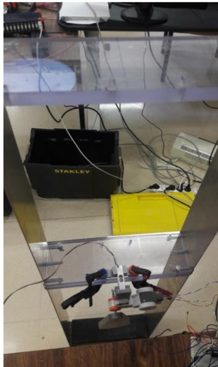
Figura 60. Disposición del motor LEGO en el plano vertical en el piso 1, con la intención de excitar mediante oscilaciones de la excéntrica.
