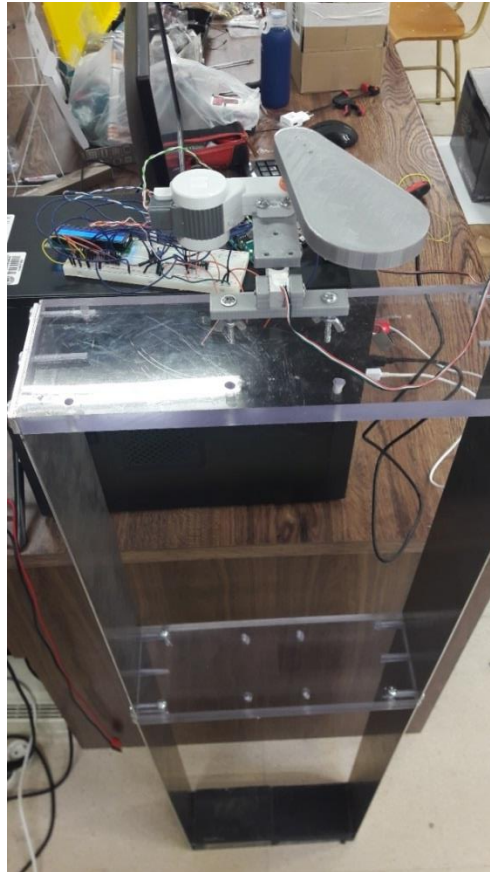
Figura 36. Motor LEGO en horizontal dando vueltas completas, excitando el modo 1 en el segundo piso.
