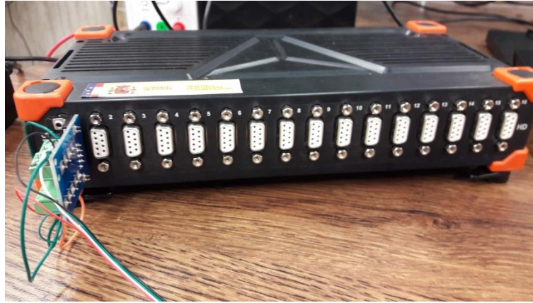
Figura 30. Equipo de adquisición y procesamiento de datos SIRIUS HD-STG, al que en el canal 1 va conectado el adaptador al que van los cables de la célula de carga.
