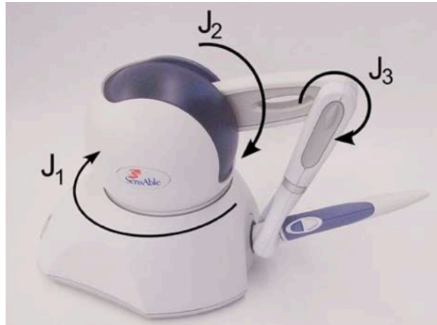
Figura 26. Articulaciones con encoder digital (posición). [22]
