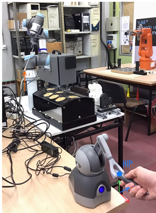
Figura 77. Movimiento lineal en sentido positivo de la dirección Y del eje del dispositivo háptico.
