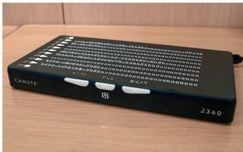
Figura 6. Instrumento electrónico de lectura en lenguaje Braille. [8]
