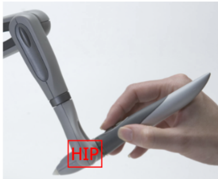
Figura 24. Stylus con localización del punto de interfaz háptico (HIP). [22]
