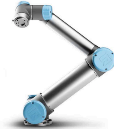
Figura 19. Robot colaborativo UR5. [17]
