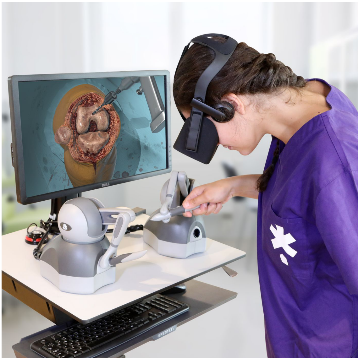
Figura 2. Ejemplo de setup para simulación con uso de interfaz háptico y realidad virtual [3].
