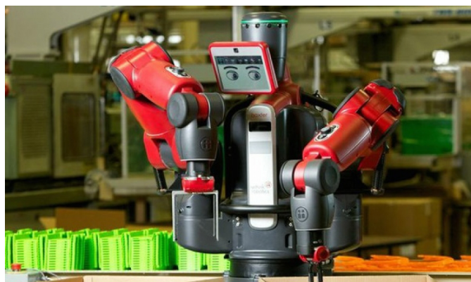
Figura 20. Robot colaborativo "Baxter" [18].
