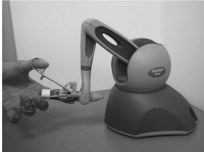
Figura 11. Geomagic Touch con modificación para herramienta quirúrgica [14].
