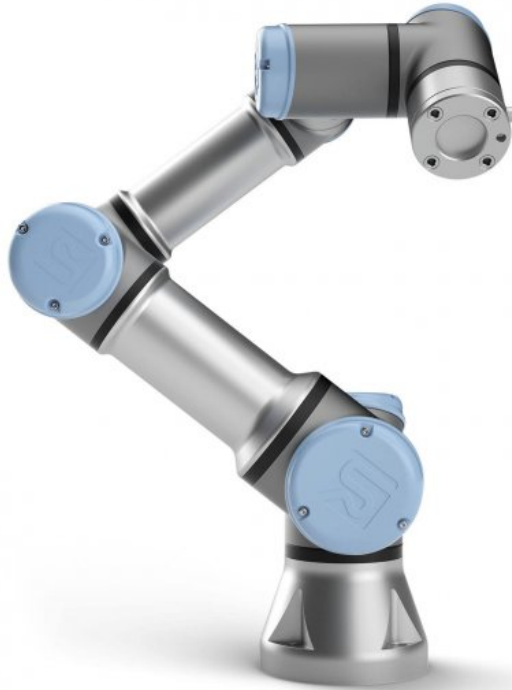
Figura 49. Robot colaborativo UR3.
