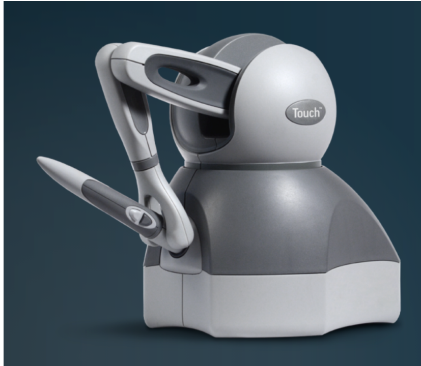
Figura 23. Sistema háptico 3D Systems Touch. [6]
