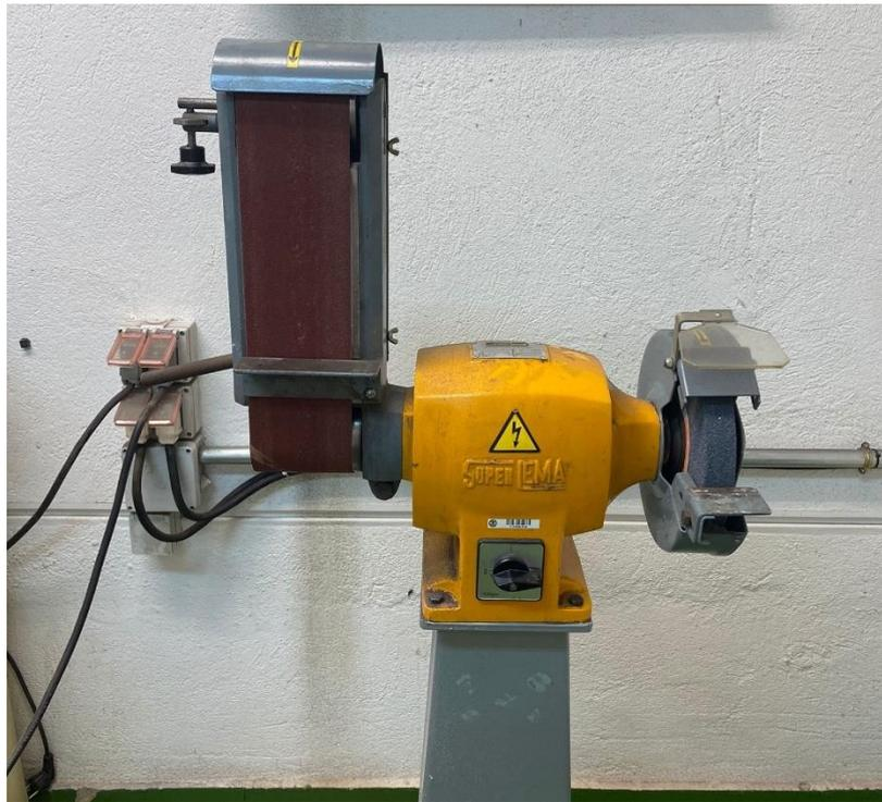
*Fig. 14. Lija gruesa para el desbaste*
