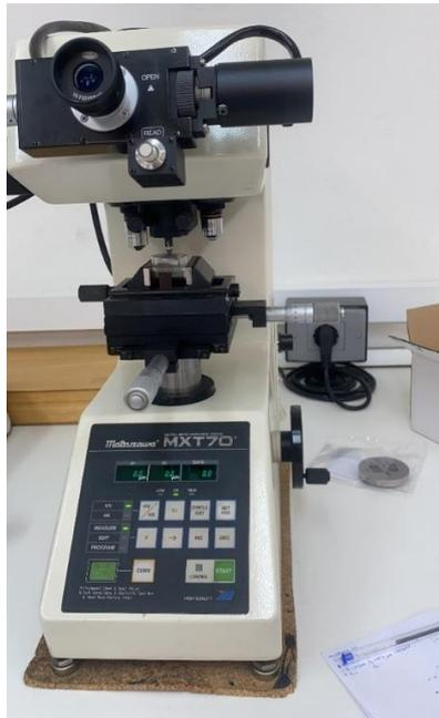
Fig. 22. Microdurómetro
