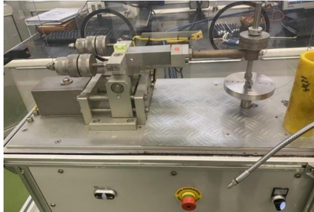
Fig. 28. Tribómetro realizando un ensayo de desgaste
