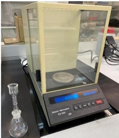
Fig. 31. Picnómetro y balanza analítica para medir la densidad
