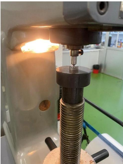
Fig. 21. Macrodurómetro realizando un ensayo Vickers
