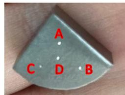
Fig. 20. Muestra tras el ensayo de macrodureza
