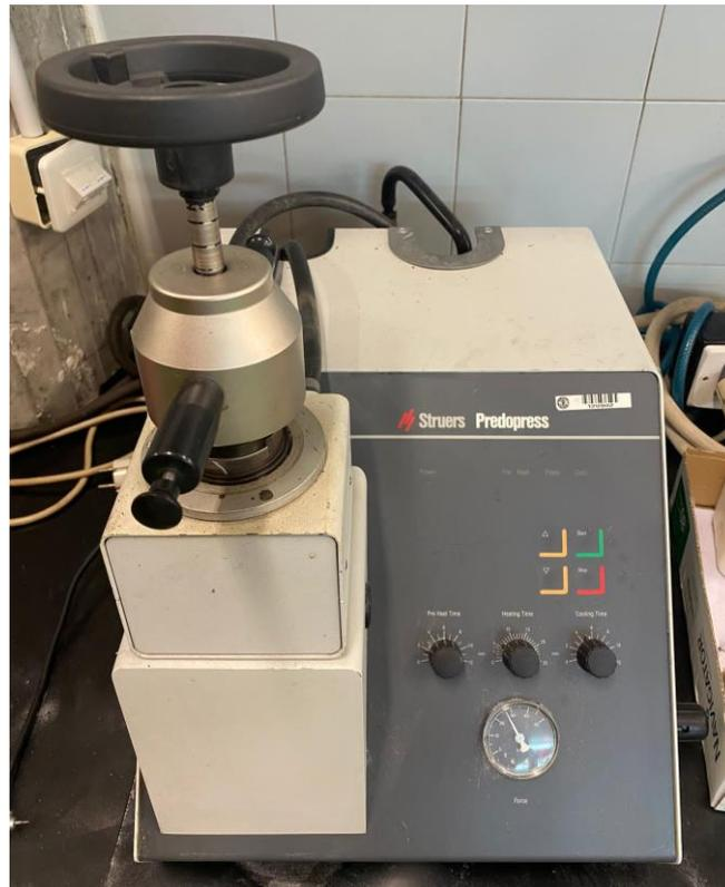
Fig. 10. Prensa metalográfica
