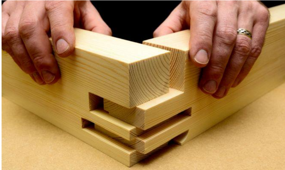
Ilustración 11| Ensamble de dentado múltiple | https://www.hogarmania.com/bricolaje/taller/tecnicas/ensamble-dentado-multiple-23671.html
