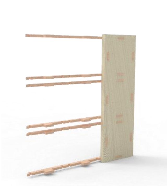
Ilustración 31. Módulos montados en estructura. Elaboración propia.
