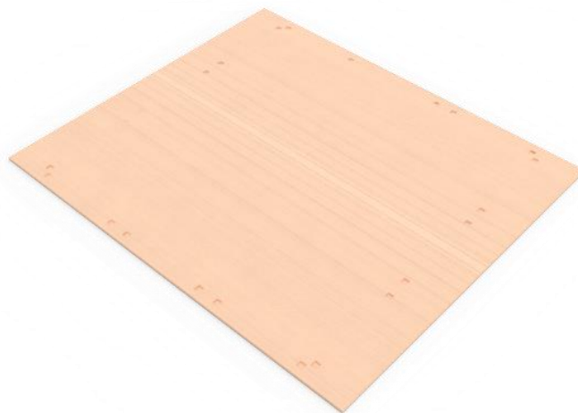
Ilustración 46| Detalle de la base con las hendiduras.
