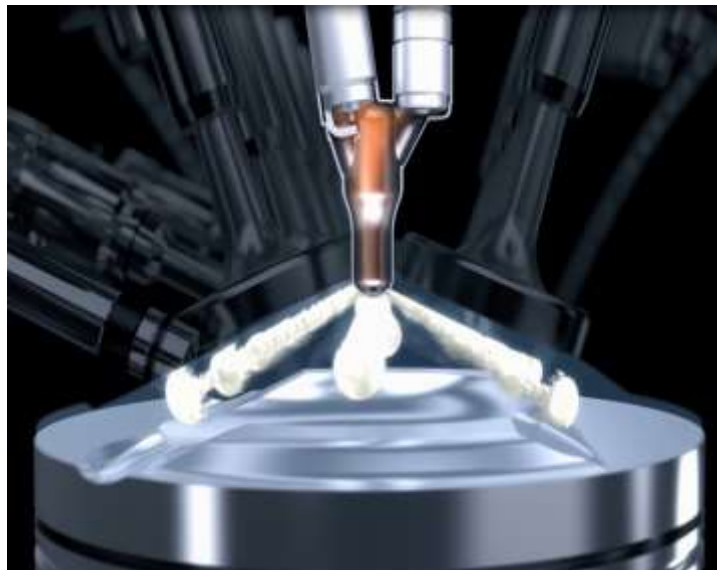
Figura 2.14. Simulación del sistema TJI activo de Mahle Powertrain [20]
