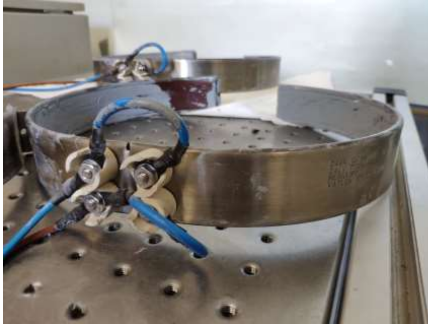
Figura 3.17. Resistencia de calentamiento del tanque externo
