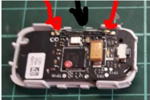
Figura 15. Circuito electrónico del sensor de puerta donde se soldarán los cables [10]
