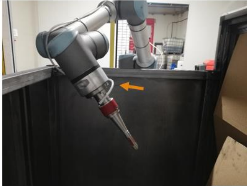
Figura 101. Problemas con el tubo de alimentación de presión de la pinza.
