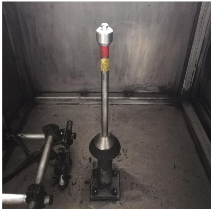
Figura 31. Soporte rotativo de la cabina de pintura.
