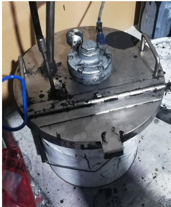
Figura 35. Sistema de suministro de pintura.
